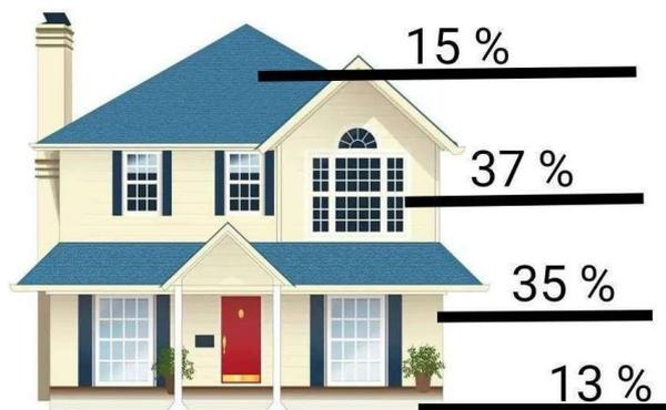
Le bâtiment perd de la chaleur à travers tous c'est les pièces, seulement le Magnitude de la perte varie. Environ 35% de la chaleur se perd à travers les murs, 37% à travers les fenêtres, 15% à travers le toit et 13% à travers le sous-sol dalle.
